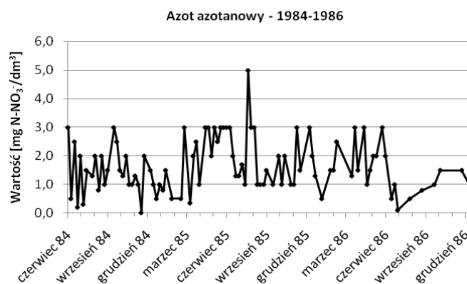
Rys. 8. Zmiany stężenia azotu azotanowego w wodzie surowej GO-CZA I w latach 1984-1986
