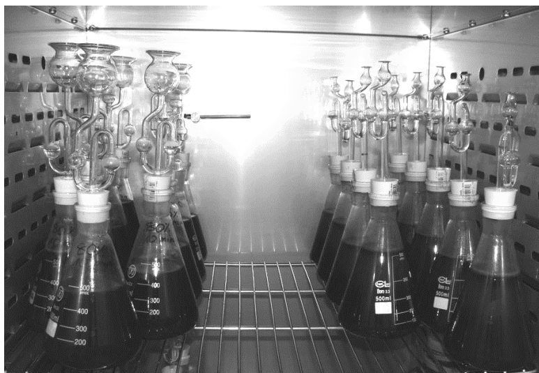
Rys. 1. Kolby laboratoryjne z mieszaniną osadu nadmiernego i osadu przefermentowanego w procesie 10-dniowej stabilizacji beztlenowej
