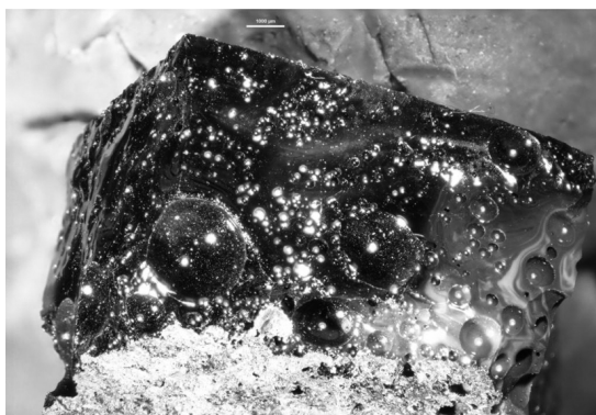
Rys. 2. Witryfikat z osadów z garbarni „Szczakowa” z procesu flotacji
