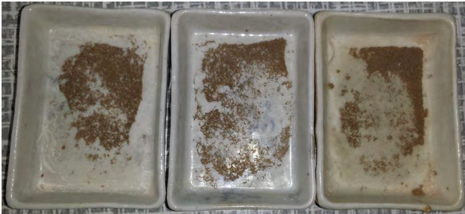
Rys. 7. Popiół z tui, otrzymany po spaleniu w piecu 850°C, przez 90 minut (opracowanie własne)
