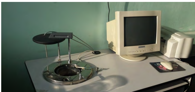
Rys. 5. Widok stanowiska pomiarowego w trakcie badania bombą kalorymetryczną (opracowanie własne)
