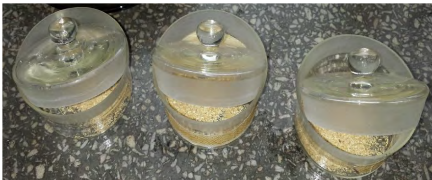
Rys. 4. Słoma przed włożeniem do suszarki elektrycznej o temperaturze 105÷110°C (opracowanie własne)
