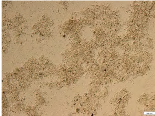
Rys. 5. Osad czynny z oczyszczalni przemysłowej po 10 minutach oddziaływania ultradźwięków - preparat niebarwiony (x200)
