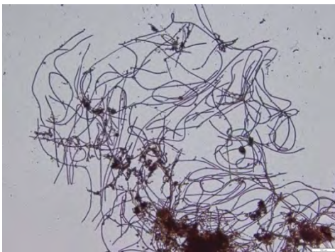
Rys. 4. M. parvicella po barwieniu Grama i Neissera (x1000) (źródło: fotografia wykonana przez autorów)
